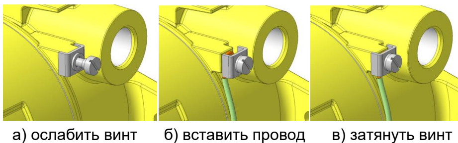
Рисунок 32 – Заземление корпуса газоанализатора
