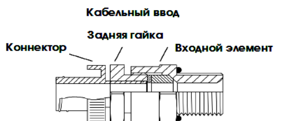
Смонтированный кабельный ввод и кабель
