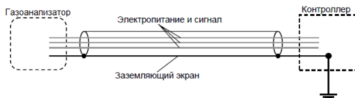
Рисунок 4 – Заземление экранированного кабеля
